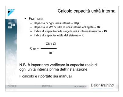
Cap. è la capacità totale di ogni unità interna espressa in Kw termici di una unità interna inserita nel sistema e serve per determinare la reale capacità della macchina, che varia con il variare delle combinazioni.
