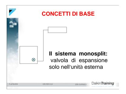
Nel sistema monosplit il controllo del refrigerante avviene nell'unità esterna e quini le unità interne no hanno alcun sistema di regolazione del refrigerante.
